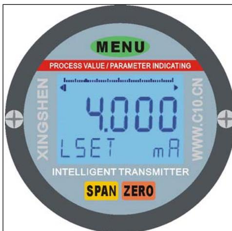
3. 按键设置零位: 传感器在不加压力或设备处于空液位, 变送器模块处于开锁状态时, 再按 **ZERO** 键 3S 显示 LSET, 零位标定成功, 变送器输出 4mA。
