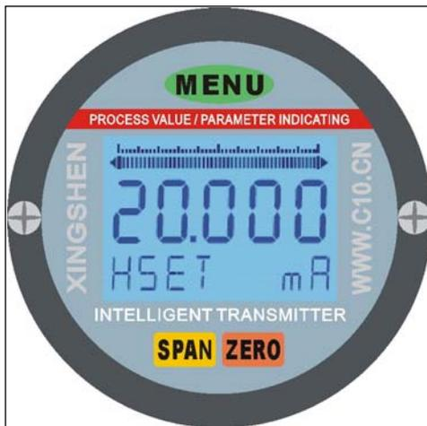
4. 按键设置量程: 传感器处于满量程压力或满液位, 变送器模块处于开锁状态时, 按 **SPAN** 键 3S 显示 HSET, 量程标定成功, 变送器输出 20mA。
