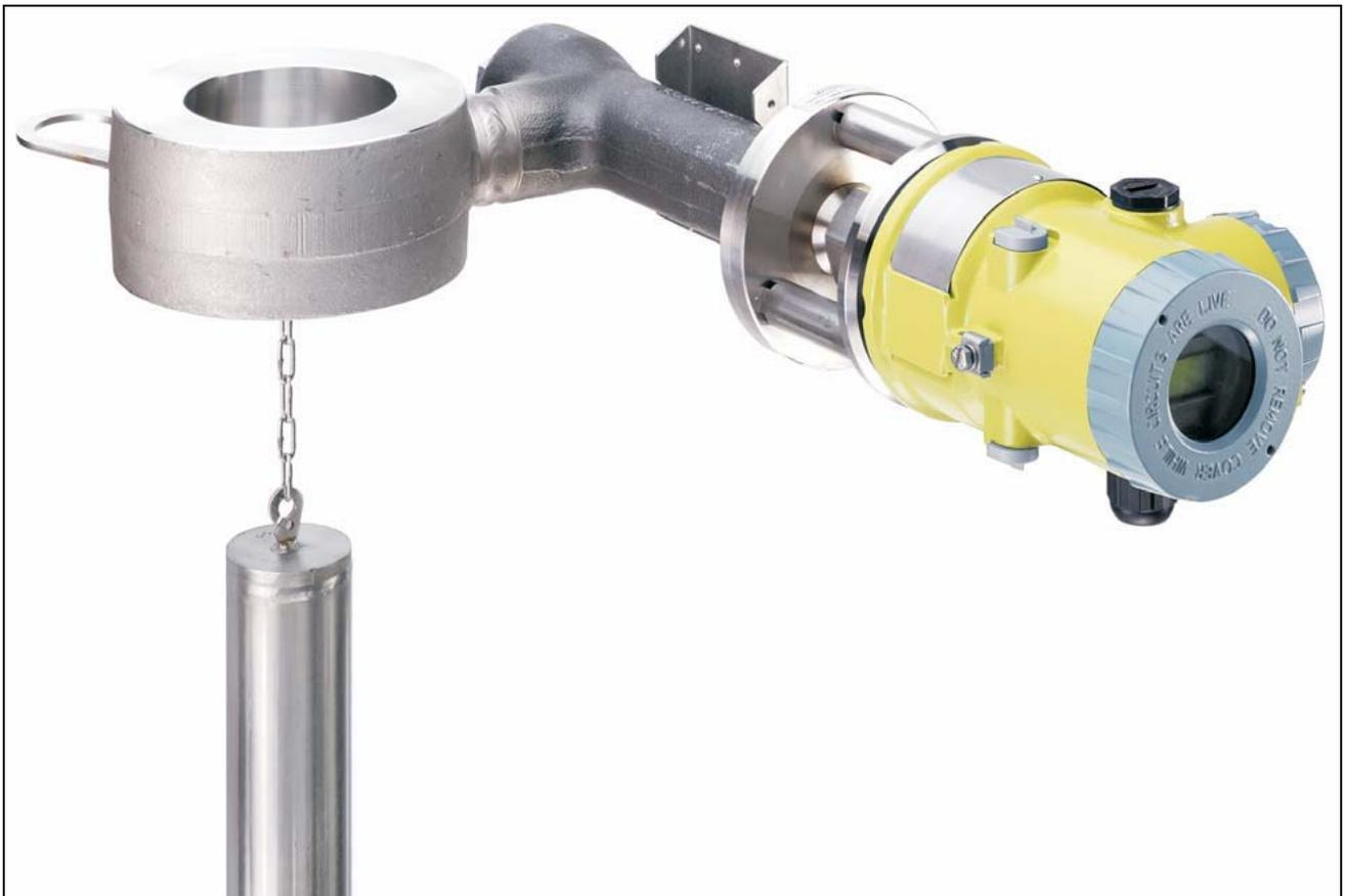
LC3244LD 液位之星智能型变送器设计用于连续测量所有的工业应用中的液体的液位、界面或密度。测量基于阿基米德浮力原理，因而产品极其坚固耐用。测量数值可以转换成模拟量和数字信号。通过 PC 或者控制系统，数字通信方便进行完整的操作和组态。即使在极高温，高压和强腐蚀性液体中，LC3244LD 始终可以稳定地、高精度地测量。它被批准可安装在爆炸性气体环境中。LC3244LD 结合了 FOXBORO ECKARDT 丰富的经验，采用了最先进的数字技术。
